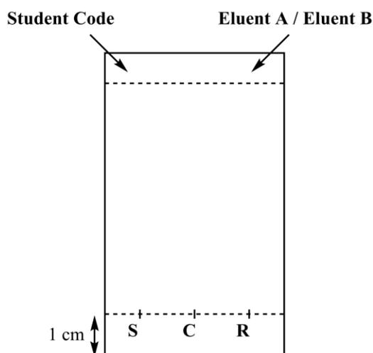
Figure 3. Preparación de la placa de TLC
