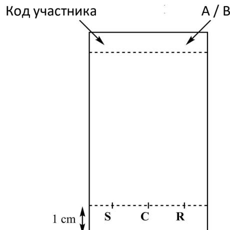
*Рисунок 3. Подготовка пластинок для ТСХ*
