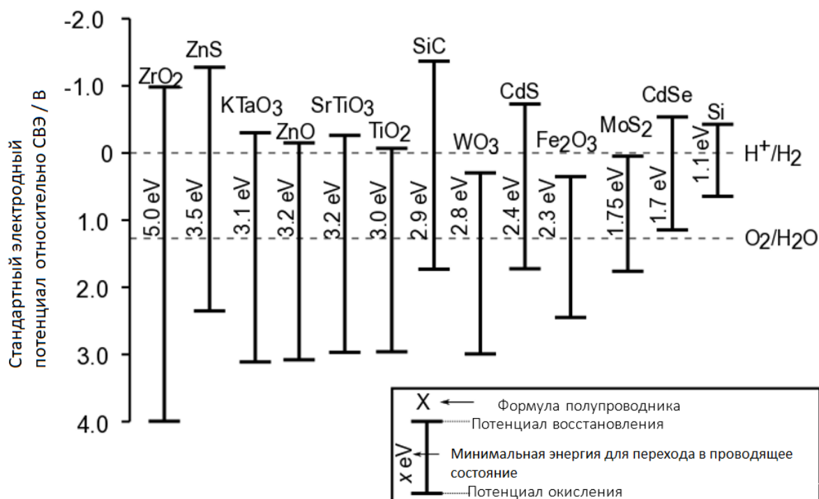
Рис. 2 – Условия перехода в проводящее состояние и электродные потенциалы различных полупроводников. Пунктирными линиями обозначены потенциалы окисления и восстановления воды. СВЭ = Стандартный водородный электрод.
