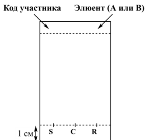
Рисунок 3. Подготовка пластинок ТСХ
