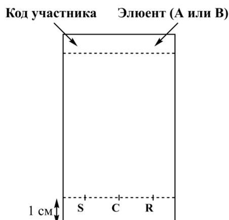
Рисунок 3. Подготовка пластинок ТСХ
